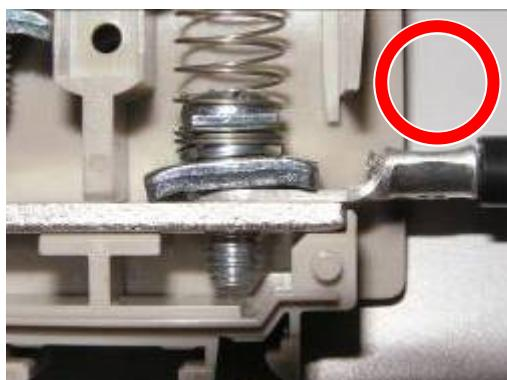
Kabeldraht ist verkantet, da eine lötfreie Anschlussklemme mit Abmessungen verwendet wurde, die nicht den Vorgaben entsprechen
