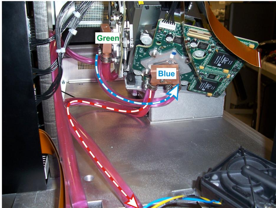
FIGURE 1-50 COOLANT HOSE ROUTING FROM DMD'S BACK TO HEAT EXCHANGER
