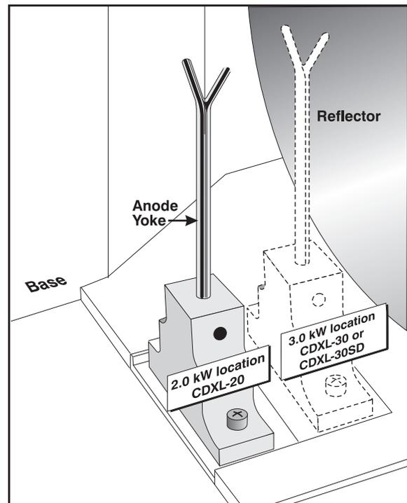
**FIGURE 1-13 ANODE CLAMP POSITION**
