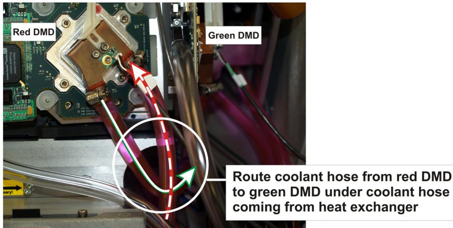
**FIGURE 1-49 CRITICAL HOSE ROUTING FROM RED DMD TO GREEN DMD**
