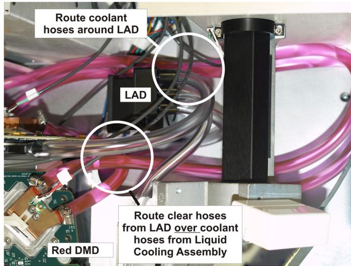
**FIGURE 1-48 CRITICAL HOSE ROUTING AROUND LAD FAN**
