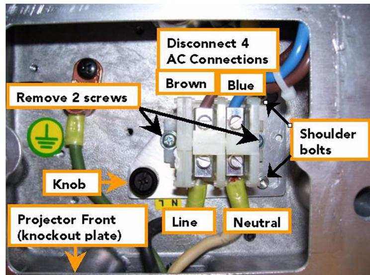
FIGURE 1-10 AC TERMINAL BLOCK
